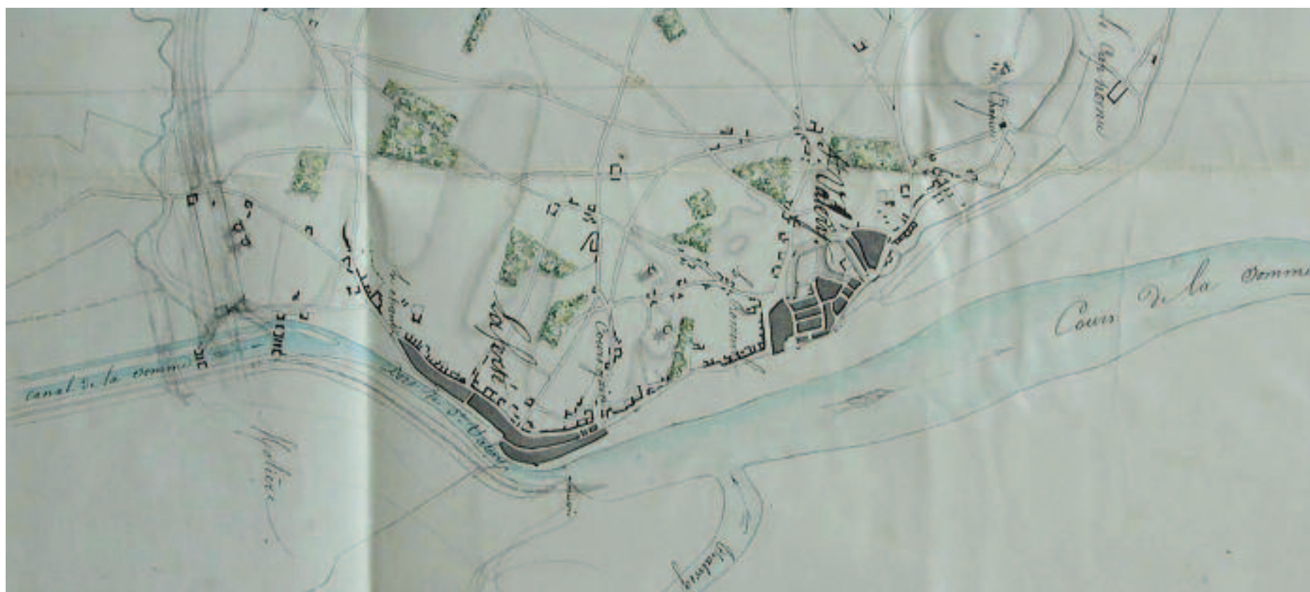
Plan général du port de St-Valery et de l'embouchure du canal de la Somme avec le tracé des murs de quai à construire sous la Ferté. 30 novembre 1835 Plan du port de St-Valery sur lequel on a tracé en rouge les travaux à exécuter pour reporter le barrage actuel dans l'emplacement indiqué par la commission de 1844. (Archives DDE Abbeville)
